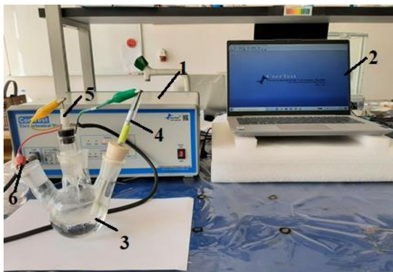
Рисунок 1 - Потенциостат-гальваностат «CorrTest Electrochemical Workstation»: 1-потенциостат; 2- персональный компьютер; 3- электрохимическая ячейка; 4-рабочий электрод (-TiO 2 ); 5-относительный электрод (хлор-серебряный); 6-вспомогательный электрод (платиновый)
